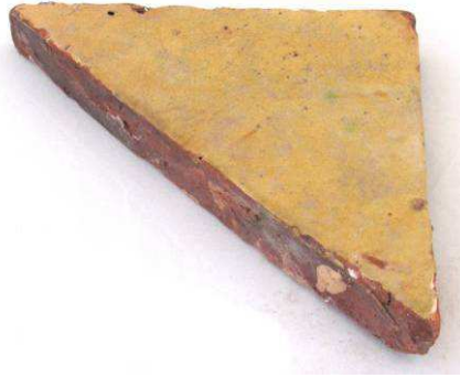
Afb. 17a-b Resten van plavuizenvloer 2C in het voorhuis van Hofstraat 15, diagonaal gelegd met gebruik van in vorm gemaakte driehoekige plavuizen
